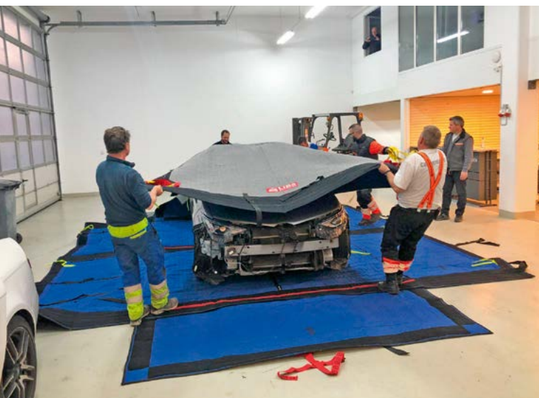
LiBaSafe heisst die feuersichere Universaldecke für die Sicherung und Bergung von verunfallten Elektroautos. Hier bei einer Schulung von Mitarbeitern des Abschleppdienstes von Aeschlimann. (Foto: Aeschlimann)
